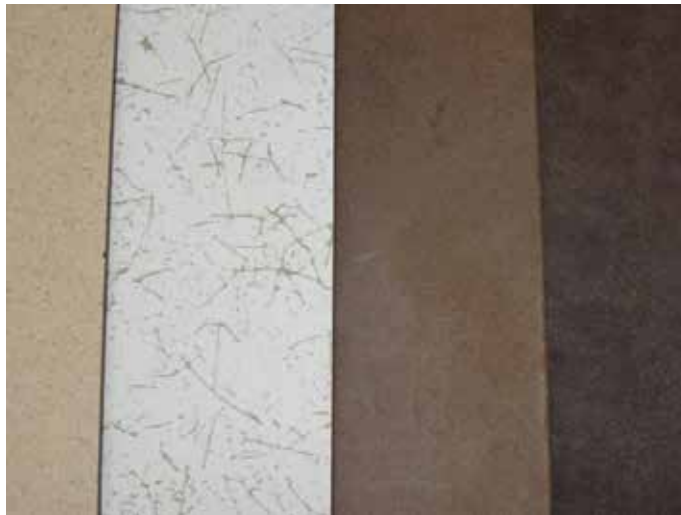
Figuur 9. Labschaal vezelplaatmateriaal op basis van kokosbolster
