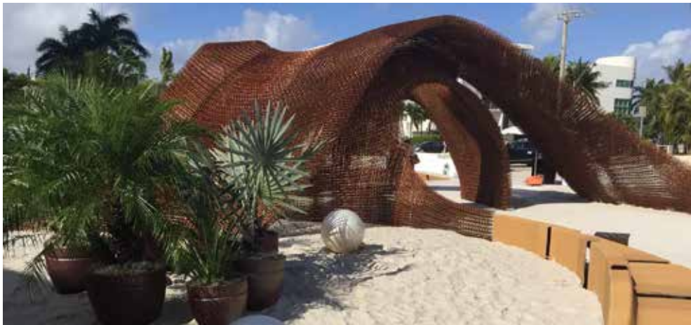
Figuur 10. 3D geprinte structuur op basis van bamboevezel versterkt PLA. Foto TechmerPM.
